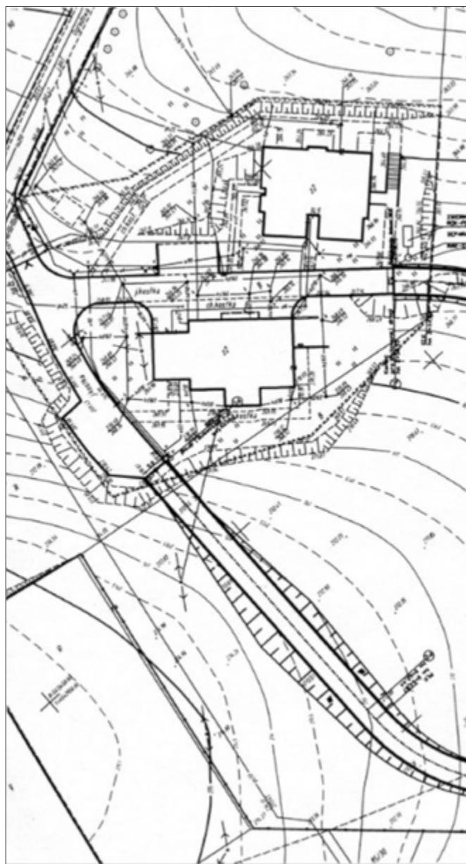
Fragment mapki z obrysem posadowienia pierwszego budynku i obrysem fundamentów projektowanego drugiego budynku (2009)
